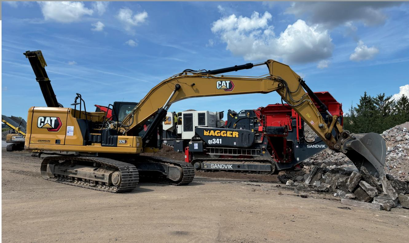
deponii. Konkrétně se linka skládá z mobilního odrazového drtiče, mobilního hrubotřídiče a obslužného pásového rypadla. Variabilita technologie umožňuje její sestavení a využití v plném spektru, nebo pouze jejích dílčích částí.
